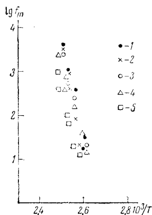
Рис. 4. Зависимость \lg f_m = \varphi(1/T) сополимеров ММА-СТ для дипольно-эластического процесса. 1—18% ММА; 2—24,4% ММА; 3—40,5% ММА; 4—55,5% ММА; 5—80,5% ММА
